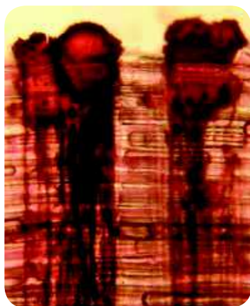
Fig. 1. Madera elaborada manchada y detalle la colonización en sentido radial por las células fúngicas de color oscuro.
